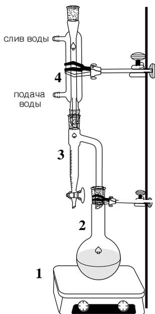
Рис. 2. Схема установки для проведения этерификации для получения эфира с температурой кипения более 100 °С.
