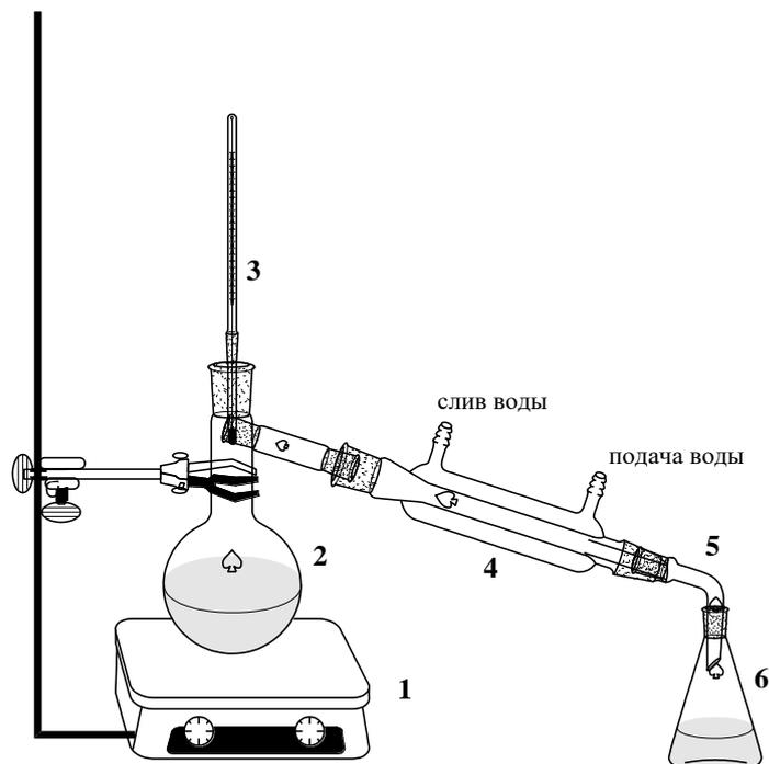
Рис. 3. Схема установки для перегонки
