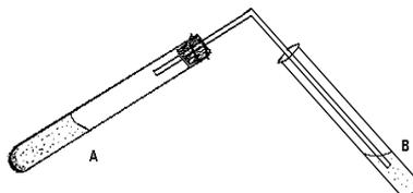
Рис. 2. Прибор для получения этилена
