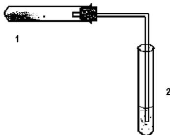
Рис. 1. Прибор для получения метана
